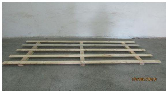
На вверх піддона укладаємо захисну плиту з HDF розміром 2800 \*1300 мм, товщиною 2 ,3 мм ,— 1шт.(фото 2.) або підкладну мdf, дсп плиту товщиною 16-18 мм.
